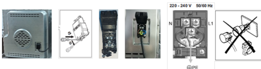
Фигура 2: Свързване на електрическия щепсел на фурната
