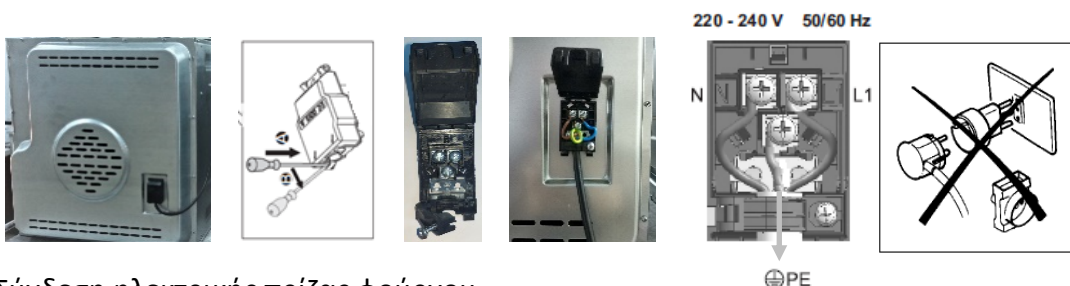
Σχήμα 2: Σύνδεση ηλεκτρικής πρίζας φούρνου
