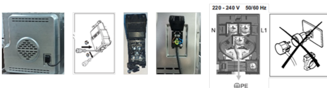
Фигура 2: Свързване на електрическия щепсел на фурната
