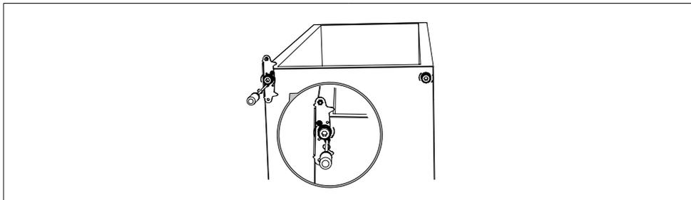
11. Nasadte dveře zpět. Před konečným utažením horního závěsu se ujistěte, že jsou dvířka vyrovnaná vodorovně a svisle, aby bylo těsnění na všech stranách uzavřeno.
