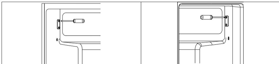
6. Przesuń pokrywę otworu zawiasu z lewej strony na prawą stronę.
