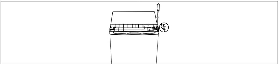
4. Schrauben Sie das untere Scharnier der Gefrierschranktür ab. Nehmen Sie dann die Tür ab und legen Sie sie auf eine weiche Unterlage, um Kratzer zu vermeiden.
