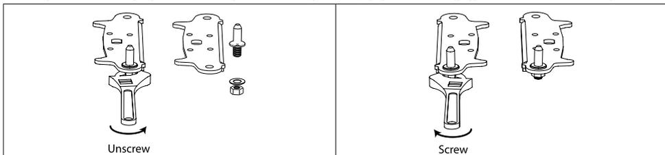
10. Τοποθετήστε ξανά το στήριγμα που προσαρμόζει τον πείρο του κάτω μεντεσέ. Αντικαταστήστε και τα δύο ρυθμιζόμενα πόδια.
