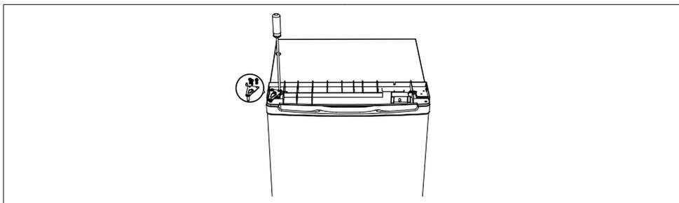
12. Puneți capacul superior și fixați-l cu 2 șuruburi pe spate.
