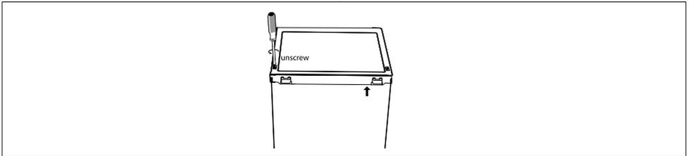
2. Entfernen Sie die obere Abdeckung und legen Sie sie beiseite.
