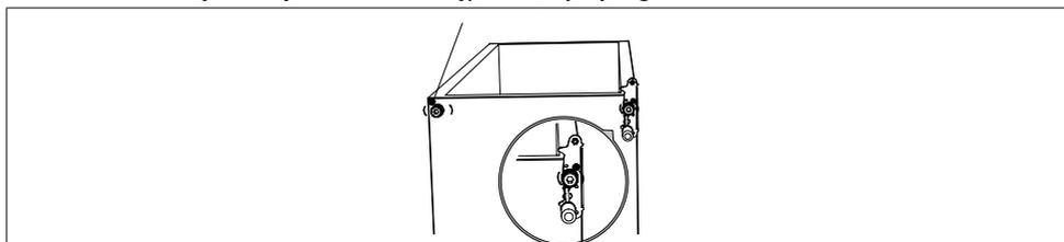
9. Odkręć i wyjmij sworznie zawiasu dolnego, odwróć wspornik i wymień go.
