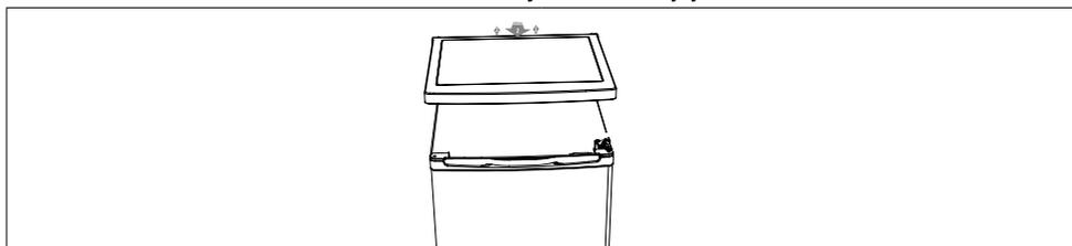
3. Odšroubujte horní pant a poté vyjměte dvířka a položte je na měkkou podložku, aby se nepoškrábaly.
