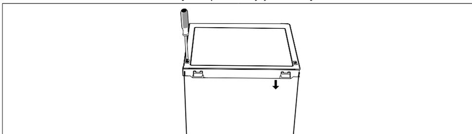
13. Oddělte těsnění dveří chladničky a mrazničky a po otočení je připevněte.
