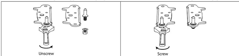
10. Namontujte zpět držák uchycující čep spodního závěsu. Vyměňte obě nastavitelné nožičky.
