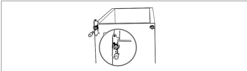
11. Puneți ușa înapoi. Asigurați-vă că ușa este aliniată orizontal și vertical, astfel încât garniturile să fie închise pe toate părțile înainte de a strânge definitiv balamaua superioară.
