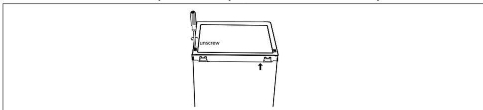
2. Odstraňte horní kryt a odložte jej stranou.
