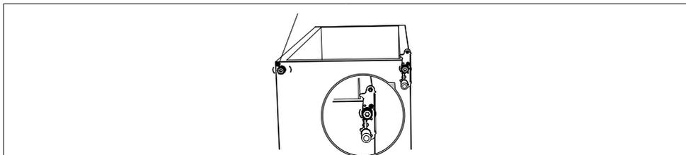
9. Ξεβιδώστε και αφαιρέστε τον πείρο του κάτω μεντεσέ, γυρίστε το στήριγμα και επανατοποθετήστε το.
