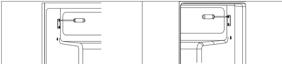
6. Přesuňte kryt otvoru pantu z levé strany na pravou stranu.
