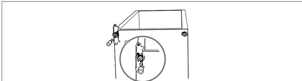
11. Setzen Sie die Tür wieder ein. Stellen Sie sicher, dass die Tür horizontal und vertikal ausgerichtet ist, so dass die Dichtungen an allen Seiten geschlossen sind, bevor Sie das obere Scharnier endgültig festziehen.
