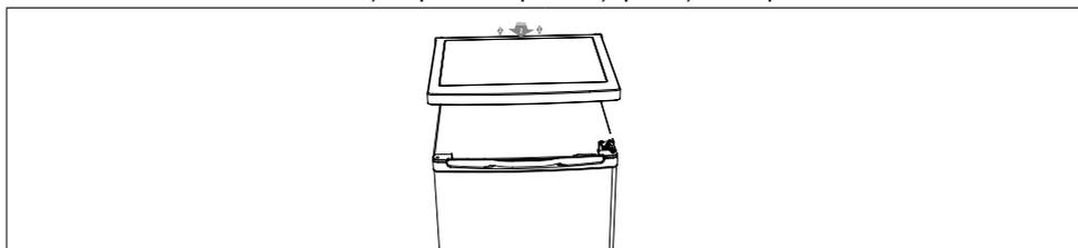
3. Deşurubaţi balamaua superioară, apoi scoateţi uşa şi aşezaţi-o pe un tampon moale pentru a evita zgârieturile.
