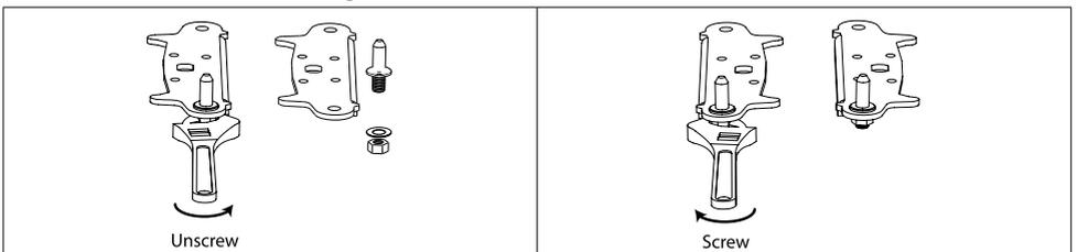
10. Bringen Sie die Halterung wieder an und montieren Sie sie am unteren Scharnierstift. Tauschen Sie beide Stellfüße aus.
