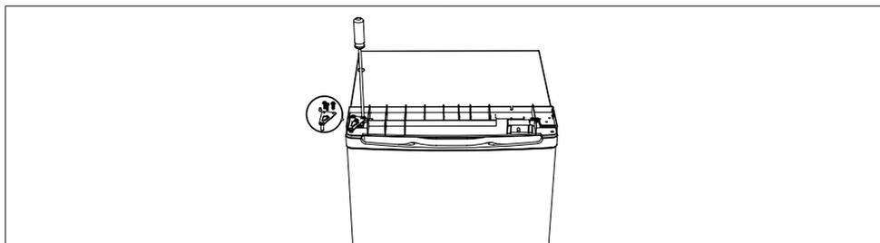
12. Setzen Sie die obere Abdeckung auf und befestigen Sie sie mit 2 Schrauben auf der Rückseite.
