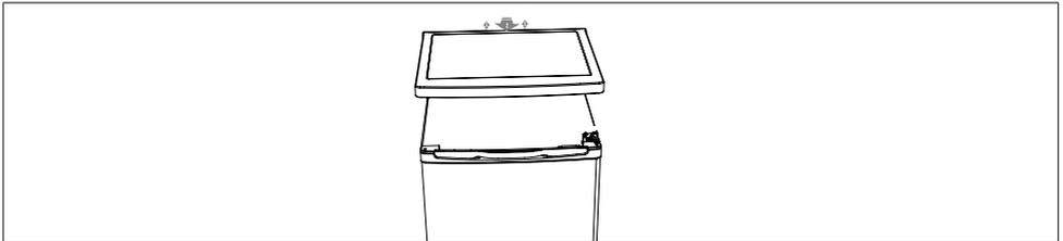
3. Schrauben Sie das obere Scharnier ab, nehmen Sie dann die Tür ab und legen Sie sie auf eine weiche Unterlage, um Kratzer zu vermeiden.
