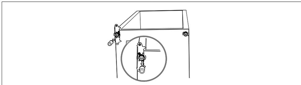
11. Załóż z powrotem drzwi. Upewnij się, że drzwi są wyrównane poziomo i pionowo, tak aby uszczelki były zamknięte ze wszystkich stron przed ostatecznym dokręceniem górnego zawiasu.
