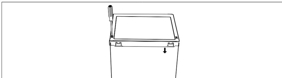
13. Nehmen Sie die Türdichtungen des Kühl- und Gefrierschranks ab und bringen Sie sie nach dem Drehen wieder an.
