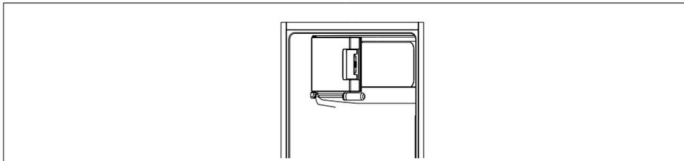
8. Deșurubați balamaua inferioară. Apoi scoateți picioarele reglabile din ambele părți.
