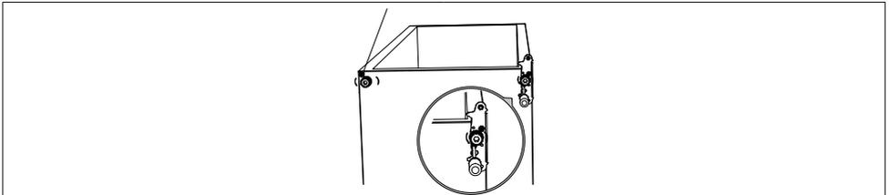
9. Schrauben Sie den unteren Scharnierstift ab, entfernen Sie ihn, drehen Sie die Halterung um und setzen Sie sie wieder ein.
